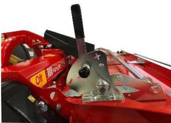
Komfortable Einstellung der Intensität. Verstellung des Konditionierungsblech in 5 Stufen und Gegenkamm mit 3 Stufen - beide Hebel haben eine Einstellskala.
