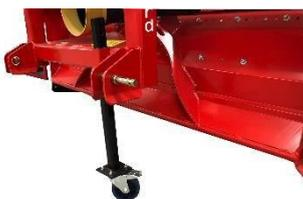
Das optionale Rangierrad unter dem Stützfuß erleichtert das An- und Abkoppeln an den Schlepper. Das Rad ist mit einer Arretierbremsen ausgerüstet.
