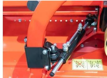
Der optionale hydraulische Schwingungsdämpfer nimmt Schläge auf und schützt die Maschine. Zusätzlich wird die Maschine in Hanglagen und beim Ausheben stabilisiert.
