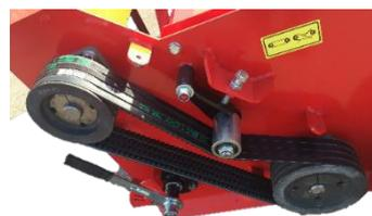
Vierfach-Keilriemenantrieb mit starker Spannungsrolle. Dieses Antriebskonzept ist zugleich eine zuverlässige Überlastsicherung.
