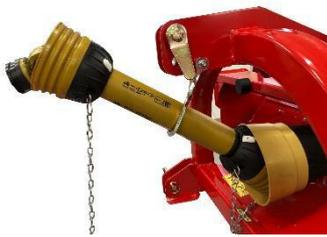
Halterung für Gelenkwelle wenn die Maschine abgekoppelt ist.
