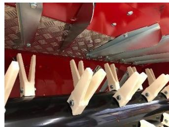
Konditionierungsblech aus geriffeltem Aluminiumblech und verschleissfeste Polyurethan-Aufbereiterzinken für beste Aufbereitungsergebnisse. Mit 14 verstellbaren Leitflügeln kann die Ablagebreite eingestellt werden.
