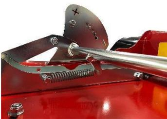
Zwei Federn unterstützen die Verstellung des Konditionierungsblechs. Mit wenig Kraftaufwand können Einstellungen vorgenommen werden.
