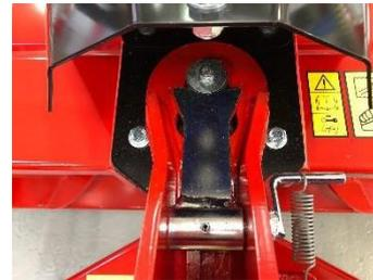
Der Schwenkbock kann für das Abkoppeln und für Strassenfahren arretiert werden. In Kurvenfahrten und auf unebenen Feldern kann die Maschine dadurch ideal den Bodenkonturen folgen.
