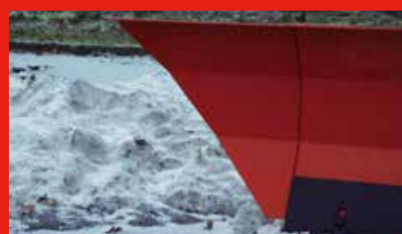
Schneeflügel, der die Kante schräg räumt, damit der Schnee nicht hinter das Schild fällt.
