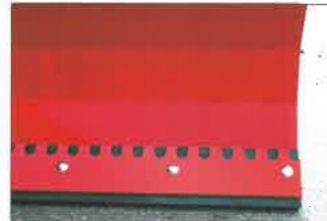
Die Gummileiste ist ideal für den Winterdienst oder das Abschieben von Beton- oder Asphaltflächen – einfach unter das vorhandene Verschleißschar montieren.
