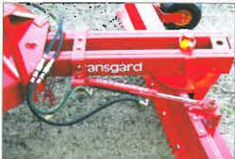
Die hydraulische Schildverstellung kann schnell demontiert und anderweitig z.B. als hydraulischer Oberlenker verwendet werden. Kann nicht auf den GT-250HY montiert werden.
