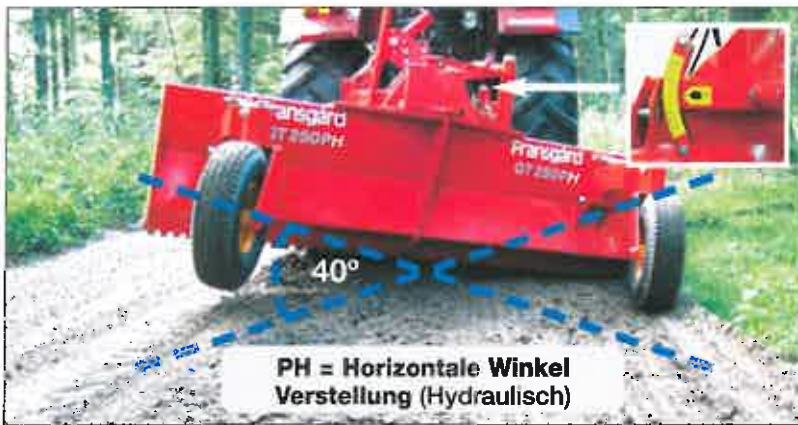
Seitliche Verstellung (Mechanisch oder hydraulisch)
