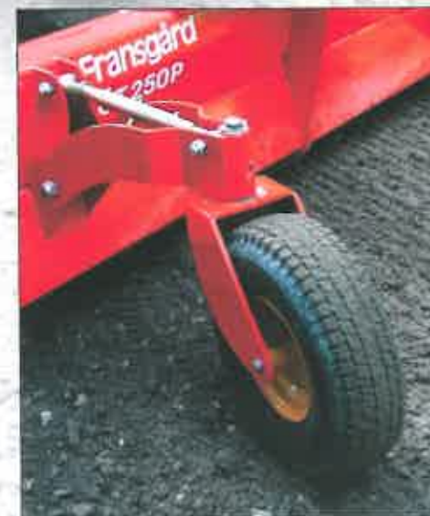
Die Angriffswinkel des Schildes kann mit den Unterlenker des Schleppers während der Fahrt durch das Langloch verändert werden. Ein hydraulischer Oberlenker bringt noch bessere Einstellmöglichkeiten.
